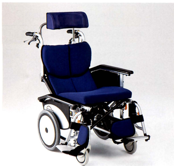
●型式:OS-12TRSP ●メーカー:松永製作所 ●折りたたみサイズ(cm):全幅27 ●チルト角度:0°~25° ●リクライニング角度:90°~115° ●材質:アルミ
